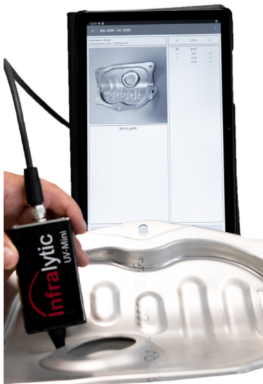
UV-Mini im Einsatz an verwinkelter Stahloberfläche
