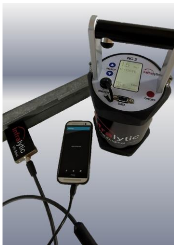
UV-Mini im Einsatz an verwinkelter Stahloberfläche
